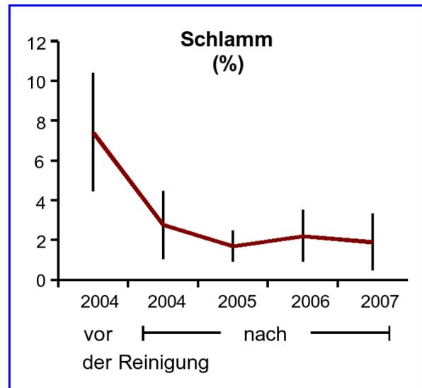
se. Ergänzt mit Steinbruchkies wird der gereinigte Bachkies wieder in den Bach eingebracht. Obwohl die Gefahr besteht, dass das gereinigte Sediment wieder neu verschlammt, blieb der **Schlammgehalt** an den meisten Stellen seit drei Jahren gering.
